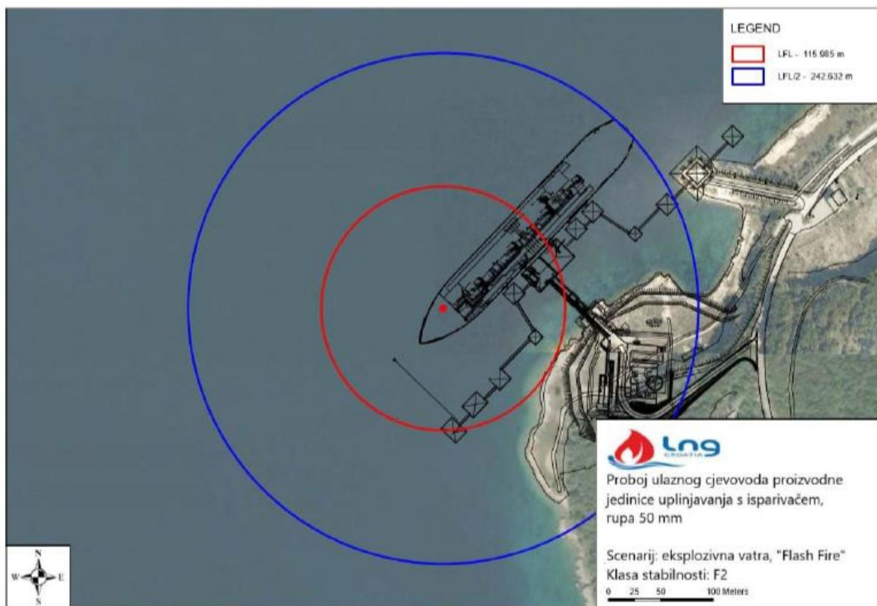
Slika 9. Zone ugroženosti uslijed istjecanja UPP-a i zapaljenja para formiranog oblaka (eksplozivna vatra) uslijed potpunog puknuća ulaznog cjevovoda proizvodne linije uplinjavanja s isparivačem za vremenske prilike klase stabilnosti F2, s brzinom vjetra 1,6 m/s
