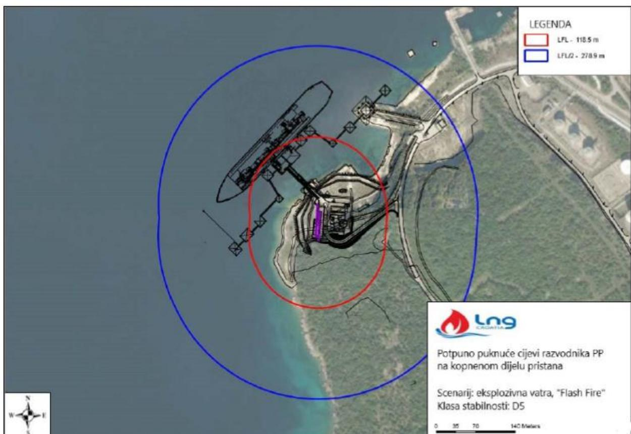
**Slika 7. Zone ugroženosti uslijed ispuštanja PP-a i zapaljenja oblaka plina (eksplozivna vatra) uslijed potpunog puknuća cijevi razvodnika PP na kopnenom dijelu pristana, za vremenske prilike klase stabilnosti D5, s brzinom vjetra 5,6 m/s**
